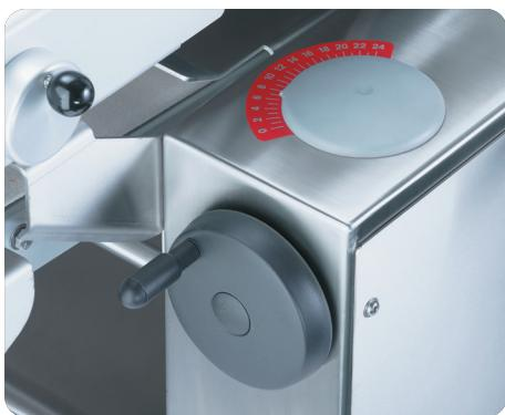
Die Wirkdruckplatte wird über ein leicht zugängliches Handrad auf den im Programm hinterlegten Wert eingestellt.
