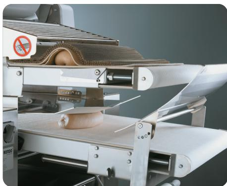
Das Teigstück wird im ersten Schritt mit einer Schleppe eingeschlagen und im zweiten Schritt in entgegengesetzter Richtung mit Hilfe der verstellbaren Druckplatte langgewirkt.
